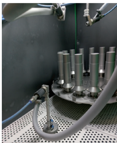
Robotstyrede blæsekabiner, hvor emnerne drejer og kan sandblæses med stor præcision.
